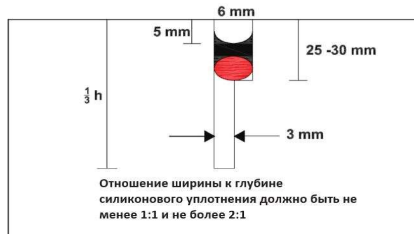
Илл. 71. Строение уплотнения шва
