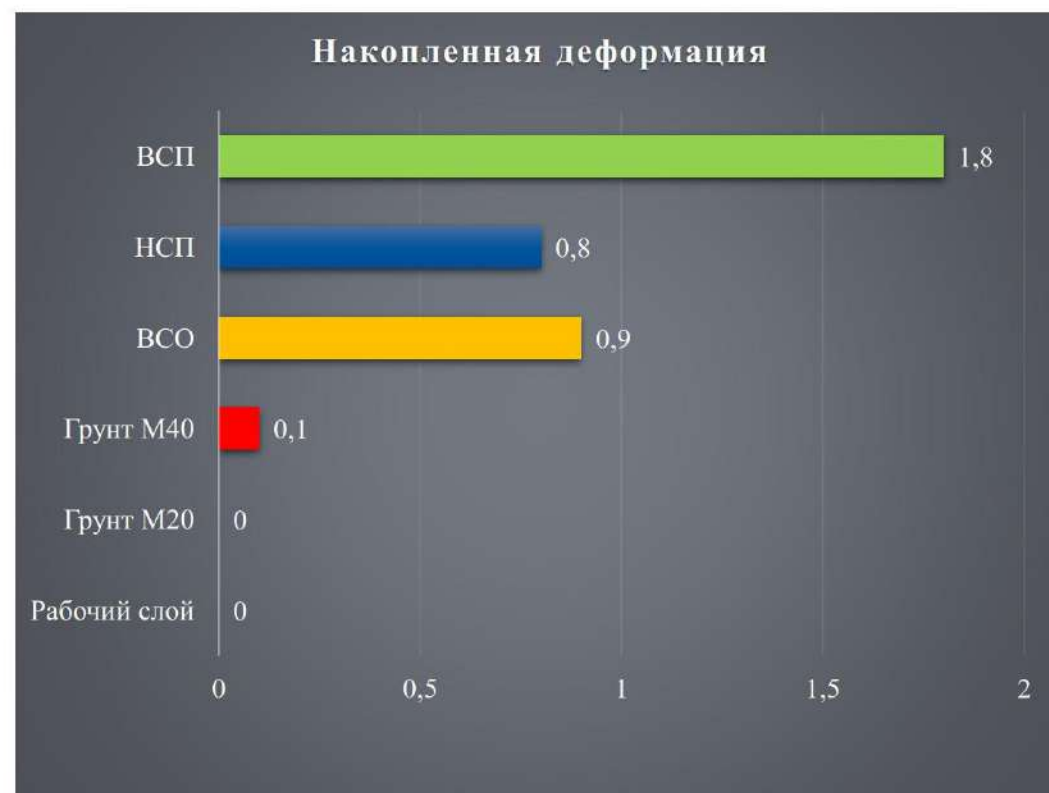
Конструкция дорожной одежды №2 (экспериментальная)
