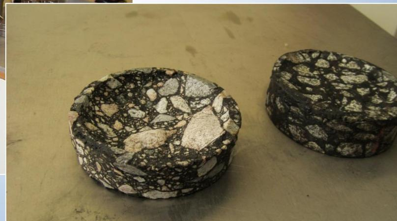
В течение 15 минут поверхность образцов подвергаются абразивному износу шариками с частотой 950 об/мин
