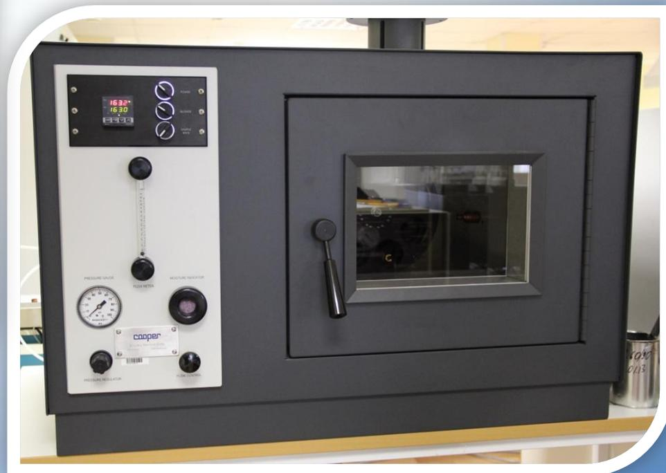
Старение вяжущего, происходящее в процессе эксплуатации дорожного покрытия в течение 5-10 лет, можно смоделировать в камере под давлением PAV:
