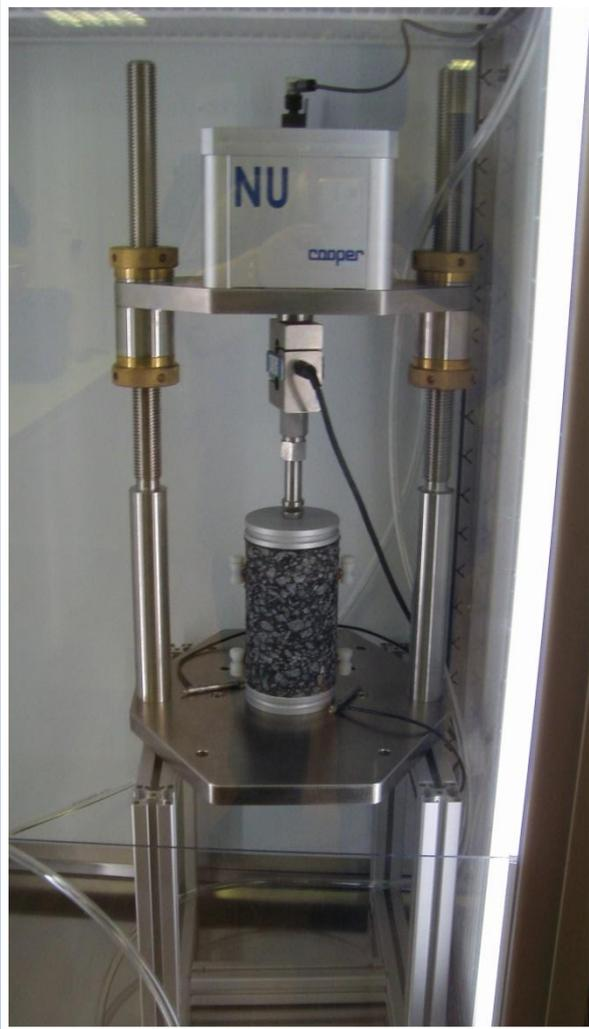
На образец асфальтобетона при заданной температуре и с заданной частотой прикладывается синусоидальная (гаверсинусоидальная) осевая сжимающая нагрузка. Затем измеряется приложенное напряжение и результирующая обратимая осевая деформация образца. Эти данные используются для расчёта динамического модуля упругости и сдвига фаз.
