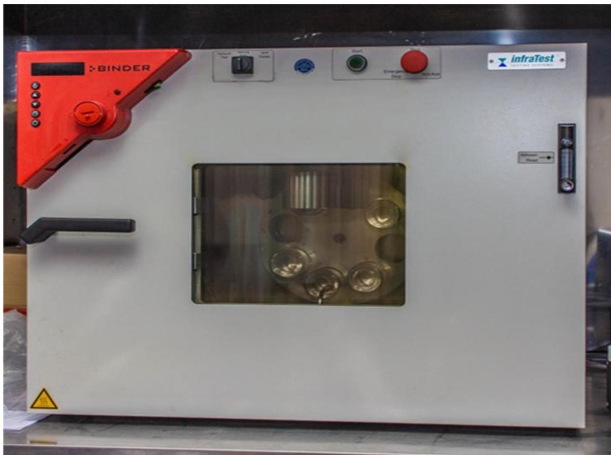
Данный метод моделирует в лабораторных условиях процесс старения битумного вяжущего, происходящий при приготовлении и укладке асфальтобетонной смеси
