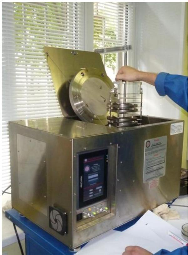
**Загрузка образцов в камеру высокого давления**
