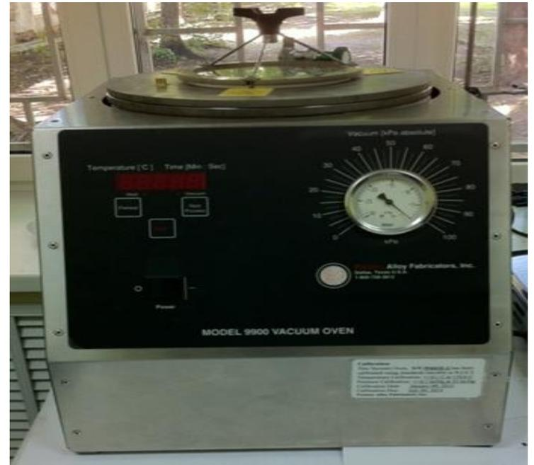
**Оборудование для длительного старения вяжущих материалов (PAV)**
