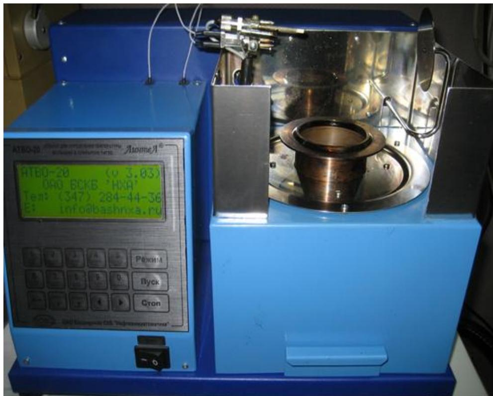
Сущность данного метода заключается в нагревании пробы битума в открытом тигле с установленной скоростью до тех пор, пока не произойдет вспышка паров битума над его поверхностью от зажигательного устройства
