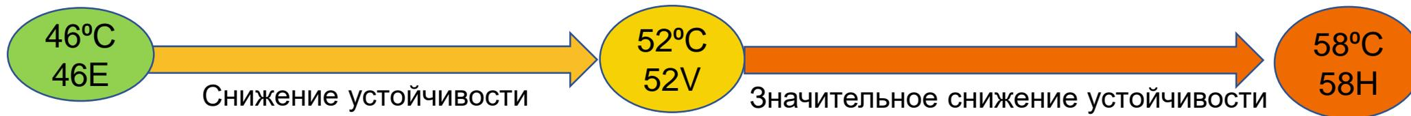
Снижение устойчивости битумов к многократным нагрузкам при «летних» температурах при обычных (3,2 кПа) и тяжелых (10,0 кПа) условиях
