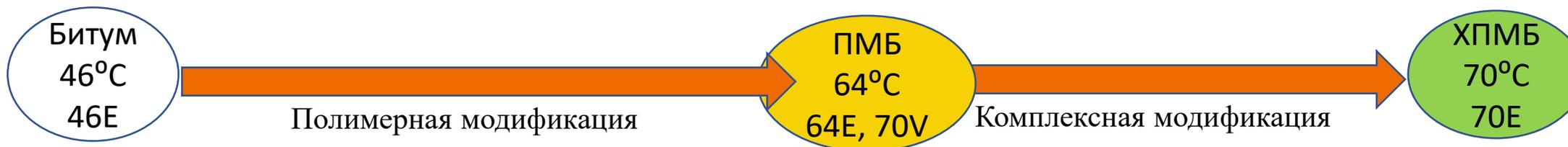
Экстремальное повышение устойчивости вяжущих к тяжелым нагрузкам при высоких «летних» температурах не только при обычных нагрузках (3,2 кПа), но и при очень тяжелых (10,0 кПа)
