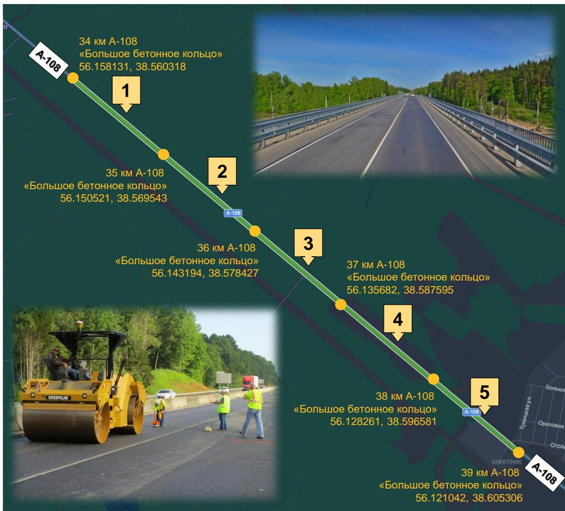
Укладка пяти экспериментальных участков протяженностью не менее 1000 м каждый с применением различных битумных вяжущих в рамках объекта ремонта автомобильной дороги А-108 «Большое бетонное кольцо» реализовано в 2018 г. под эгидой ФДА на участке Ярославско-Горьковского шоссе (км 34+000 – км 39+000).
