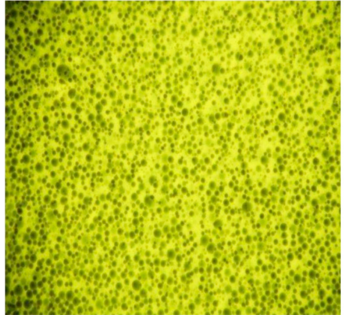
Флуоресцентная микроструктура эпоксидного битума KD
