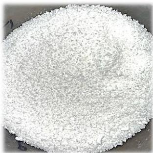
– **Стирол-бутадиен-стирол** (СБС - модификатор) – наиболее известный и применяемый при приготовлении ПБВ модификатор
