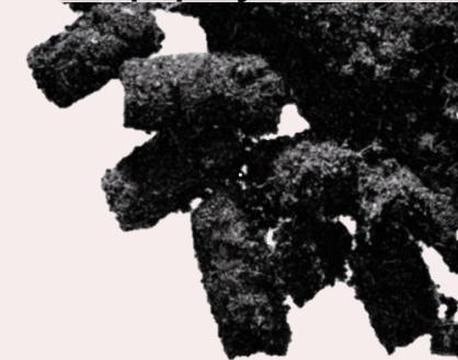
рис. 4 – гранулированный модификатор (МСБ)
